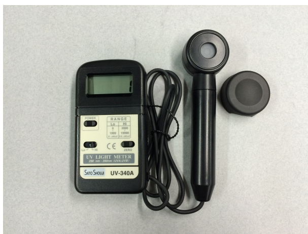
図 4.2: 紫外線強度計 UV-340A（左）と感度スペクトル（右） [37]
