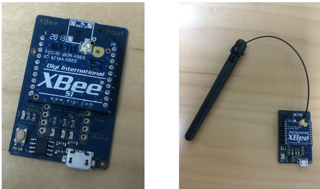
図 5.8: 無線モジュール XBee。(左): チップ単体 (右): チップ+アンテナ アクチュエータ内部ではドライバにこのチップが装着され、PC にはアンテナ付きのチップが USB ケーブルで接続される。
