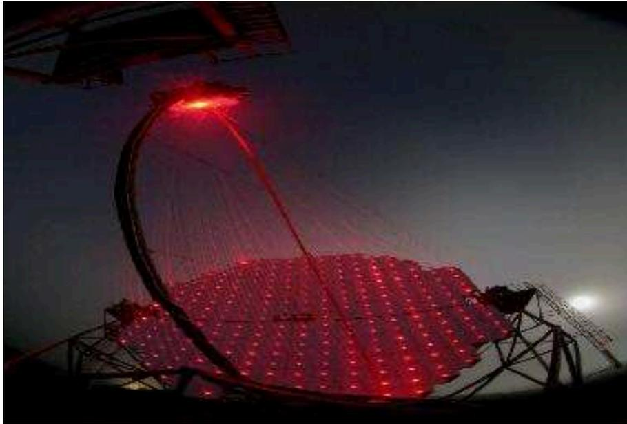
図 5.4: MAGIC 望遠鏡の AMC 用レーザー [29]
