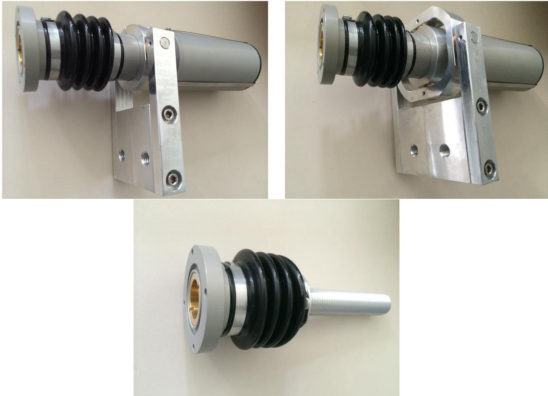
図 5.5: 2 種類のアクチュエータと固定軸。(左) : 1 軸フリー (右) : 2 軸フリー (下) : 固定軸
