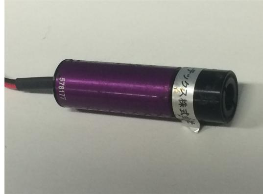
図 5.10: 実験に使用した光軸レーザー。本番でも望遠鏡中心に設置される予定。広がり角は  $0.3\text{mrad} \times 0.6\text{mrad}$ 。
