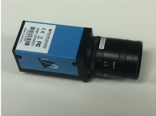
図 5.9: CMOS カメラ DMK23GM021 と焦点距離 35mm レンズ。
