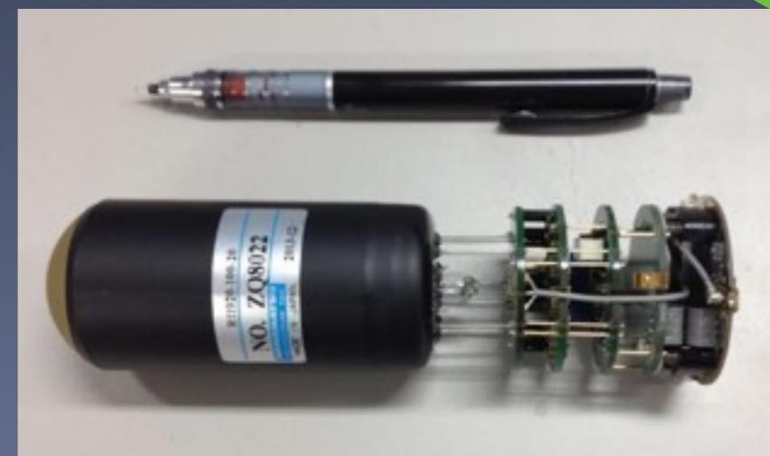
チェレンコフ光の密度が低くなる低エネルギー側(20-200GeV)を観測するため、より高い感度・S/N・光量分解能の光検出器が求められる
