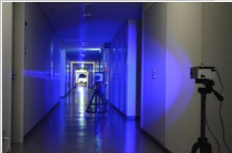
1. 光源 - 鏡の光軸上にスクリーンを配置・撮影し、カメラの 1 pixel あたりの光量を測定。
