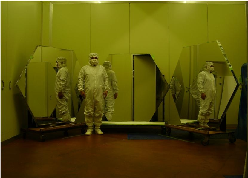
上図：1.5幅試作鏡
